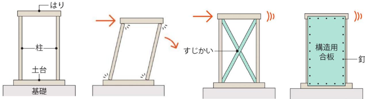
一般的な木造住宅では、基礎・土台の上に柱を立て、柱の頭をはりをつないでいます。
