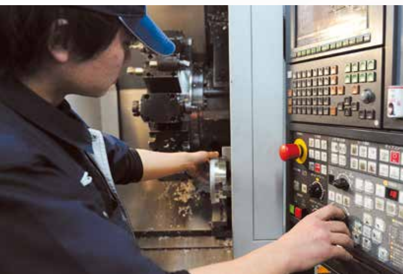
▲規格どおり精密に金属を削り出す装置
