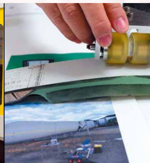
▲傷などを発見するセンサーとプロペラの一部
