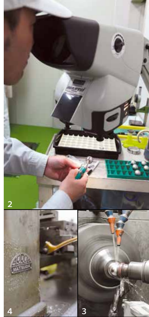
1. 医療専門の久代工場で、人工骨を加工する装置について話す重田社長 2. 大腿骨の中心になる金属球の傷などを綿密にチェック 3. 金属球を完全な球形に加工する装置 4. 長年使われてきた自社製の工作機械
